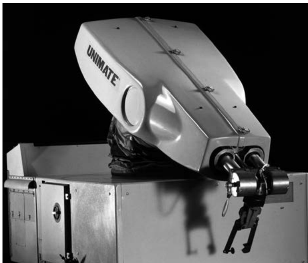
Il braccio di Unimate , il primo robot industriale, progettato da George Devol e Joseph Engelberger.
