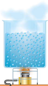
FIGURA 23 L'ebollizione avviene anche nelle parti profonde del recipiente che contiene un liquido.
