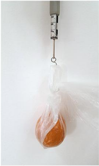
FIGURA 3 Il dinamometro è lo strumento di misura del peso.
