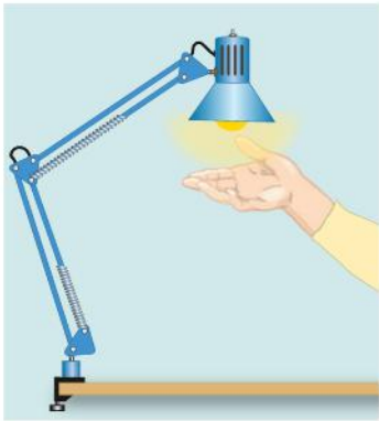
FIGURA 16 Il calore giunge alla mano per irraggiamento.
