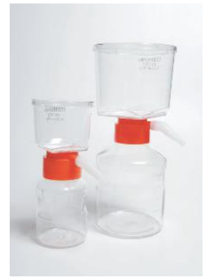
Sistemi di filtrazione su membrana.
