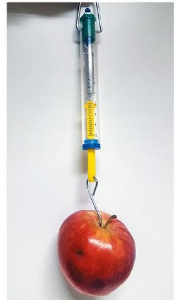
FIGURA 2 Il dinamometro è lo strumento di misura del peso.
