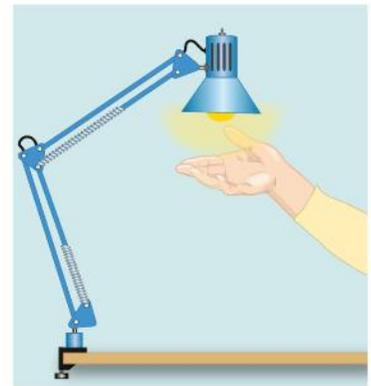
**FIGURA 19** Il calore giunge alla mano per irraggiamento.
